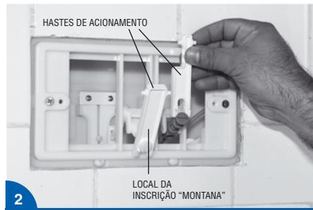
ENCAIXE AS HASTES DE ACIONAMENTO NOS ENCAIXES DO PARAFUSO VERDE E DO BRANCO. NOTE QUE, NAS HASTES BRANCAS, A INSCRIÇÃO "MONTANA" DEVERÁ FICAR DE FRENTE PARA O MONTADOR, E A HASTE DO PARAFUSO VERDE, TEM UM RECORTE DIFERENCIADO.
