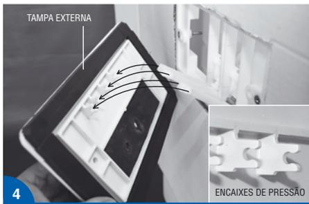
APÓS O ENCAIXE DAS HASTES NO PARAFUSO VERDE E NO BRANCO, PROCEDA AGORA COM A MONTAGEM DA TAMPA EXTERNA CONFORME DEMONSTRADO, UTILIZANDO OS ENCAIXES DE PRESSÃO PARA FIXAÇÃO DAS HASTES DE ACIONAMENTO BRANCAS.
